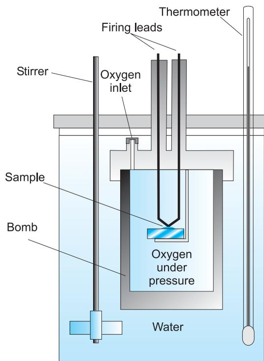
Fig. 6.7 Bomb calorimeter
